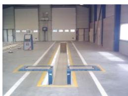
**Un freinomètre** par ligne de contrôle conforme aux dispositions de l'arrêté du 18 août 1955 modifié relatif au freinage des véhicules automobiles et répondant au cahier des charges approuvé par le ministère chargé des transports.
