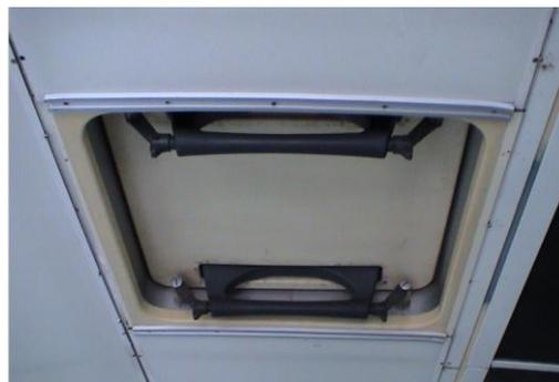
« La surface cumulée de ces dispositifs doit être supérieure ou égale à 1 % de la surface du plancher du véhicule. Une trappe d'évacuation des passagers dans le toit peut constituer un tel dispositif.
