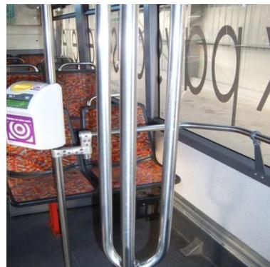
« Les barres et poignées de maintien et rambardes doivent avoir une section qui permette aux passagers de les tenir facilement et fermement. Aucune dimension de préhension ne doit être inférieure à 1,5 cm, ni supérieure à 5 cm. Les poignées de maintien peuvent être fixées aux portes ou aux sièges. Les barres fixées sur les porte-bagages doivent être à un niveau différent de la base de ceux-ci, de façon à rester accessibles en permanence.
