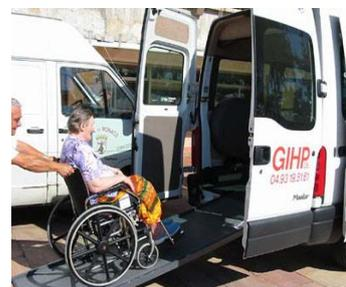
3.11.3.2.2. Un dispositif de sécurité (par ex. un mécanisme d'inversion) doit protéger les zones non visibles par l'opérateur et où le monte-charge en mouvement est susceptible de coincer ou d'écraser des objets.
