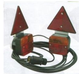
Il doit être muni de deux feux de position, de deux feux stop et de deux feux indicateurs de direction, fonctionnant en concordance avec les feux de même nature du véhicule de remorquage.
