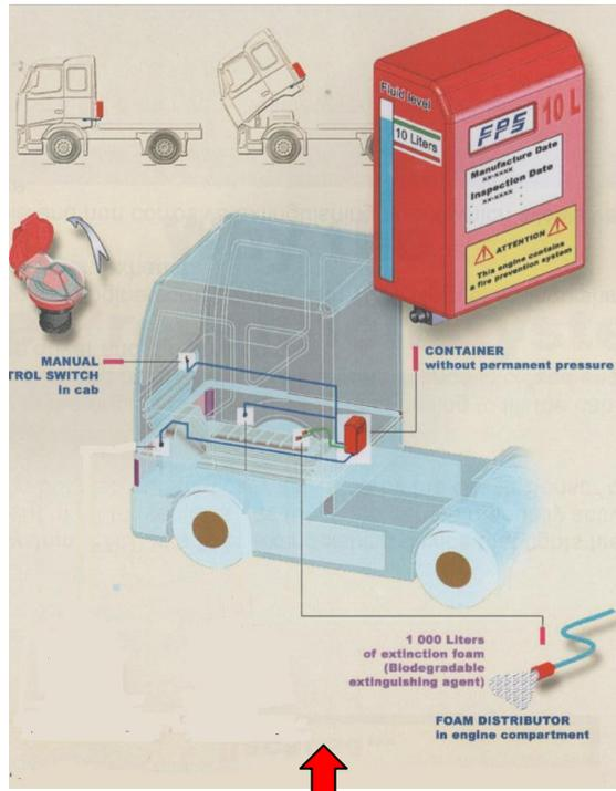
Système simple avec un détecteur de fumées ou de température dans le compartiment moteur entraînant le déclenchement d'un ou plusieurs extincteurs
