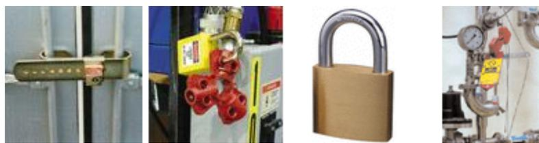
Quelques exemples de verrouillage au niveau des conteneurs, compartiments, outillages et vannes...
