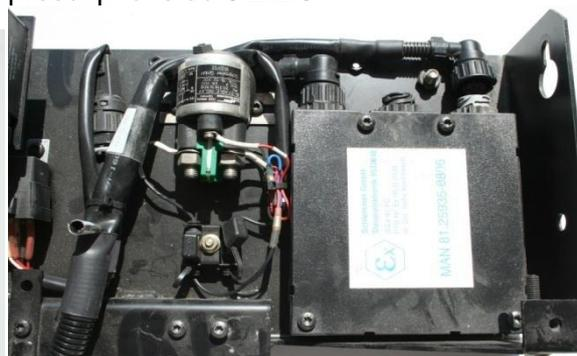
9.2.2.3.3 L'interrupteur doit être placé dans un boîtier ayant un degré de protection IP65 conforme à la norme CEI 529. Obligatoire uniquement sur les véhicules FL.
