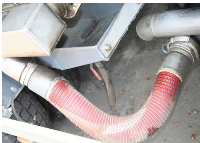
Flexible de liaison de la citerne au volucompteur
