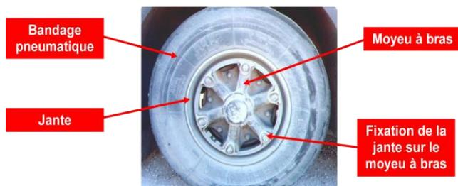
L'évolution du matériel a entraînée la disparition du moyeu à bras, une nouvelle pièce métallique soudée à la jante, "le disque", permettant sa fixation avec des écrous sur le tambour de frein munis d'axes filetés.
