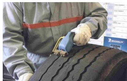
Le recreusage des pneus poids lourd est une opération autorisée par le code de la route et recommandée par l'E.T.R.T.O. et les fabricants pour plus de sécurité et plus de longévité des pneumatiques.
