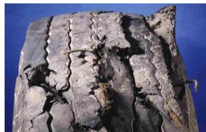
Il y a alors un risque important d'infiltration d'air dans les composants du pneu, d'une oxydation des nappes métalliques pouvant provoquer la dislocation de l'enveloppe.
