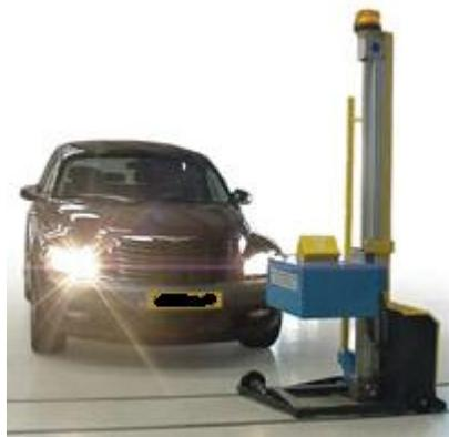
Avancer le véhicule à vitesse réduite, arrêter doucement le véhicule **sur la zone de contrôle du réglage des feux**, roues avant en ligne droite.
