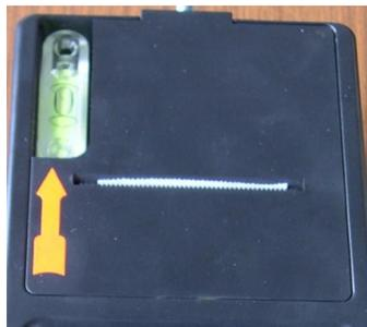
Le niveau situé sur l'appareil permet de positionner horizontalement ce dernier.
