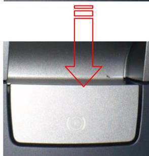
Une fois le véhicule à l'arrêt, **tirez le levier (fléché)** vers le haut et relâchez le. Le témoin d'EPB rouge s'allume sur le tableau de bord.
