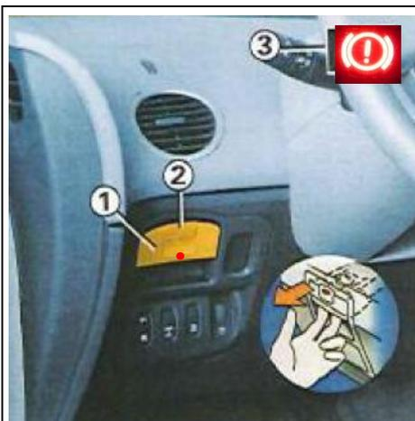
Le serrage du frein de parking est confirmé par l'allumage fixe du témoin **2** sur la planche de bord et du témoin **3** au tableau de bord. Les témoins **3** et **2** s'éteignent au verrouillage des portes.
