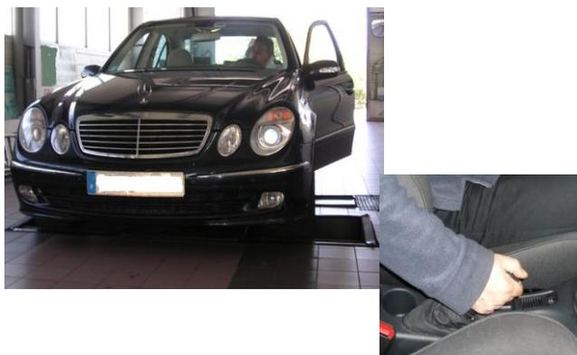
② 1<sup>er</sup> cas : banc conforme à la norme NF R 63 - 701 (édition de 1990) et au cahier des charges de l'instruction technique SR/V/ 003
