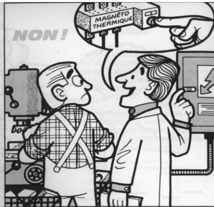
Les seules commandes autorisées pour le personnel de production sont celles qui sont prévues à l'extérieur des tableaux, armoires ou coffrets (bouton-poussoir, interrupteur, disjoncteur, etc...).
